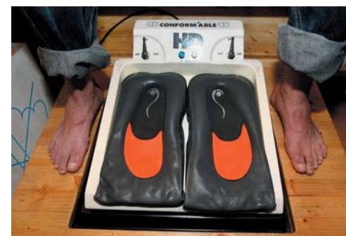
Molde que actuará como negativo de las plantillas y pies. Abajo, las plantillas quedan con la forma de nuestro arco plantar, listas para colocarlas en el interior del botín.
