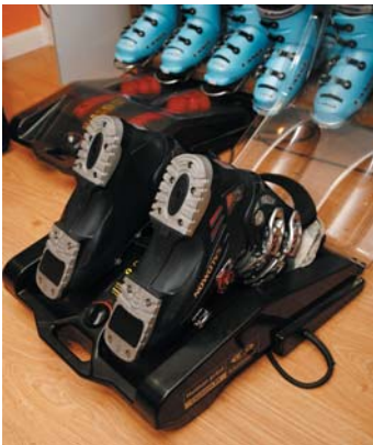
Máquina para moldear las botas con calor. Primero se calienta el botín y, luego, nuestros pies harán de molde para la forma del botín.
